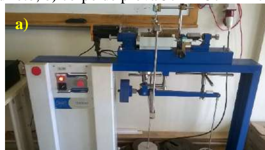
Figura 4. a) Equipamento de cisalhamento direto; b) corpo de prova 5cm x 5cm x 2cm
