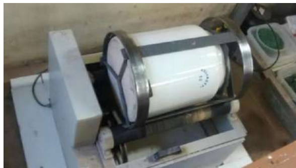
Figura 2. Moinho utilizado para moagem da cinza
