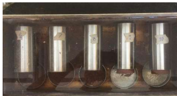
Figura 4. Ensaio de Perda de Massa por Imersão
