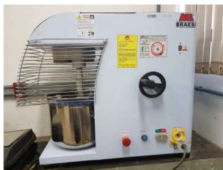
Figura 2. Misturador mecânico para preparação do solo artificial.
