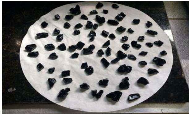
Figura 3. Ensaio de adesividade.
