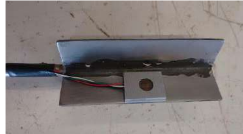
Figura 4 – Palheta de 40mm com transdutor de pressão acoplado
