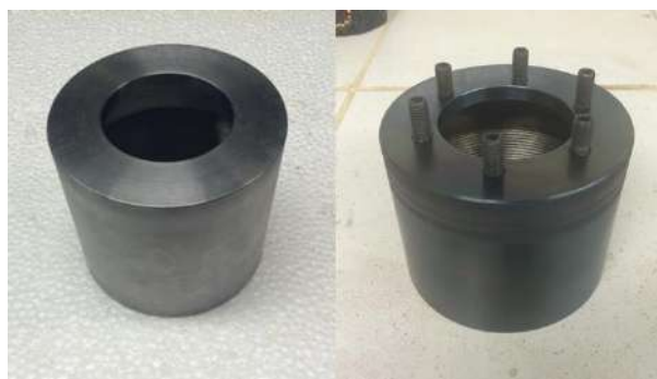
Figura 4. Copo de acoplamento do sistema de rotulagem antes (na esquerda) e após adaptação (na direita)
