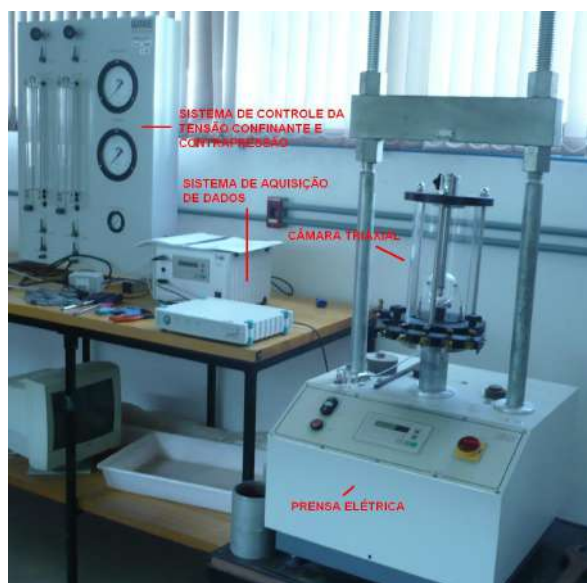
Figura 8. Arranjo experimental para os ensaios triaxiais
