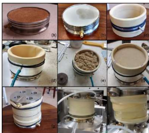
Figura 4. Preparação das amostras
