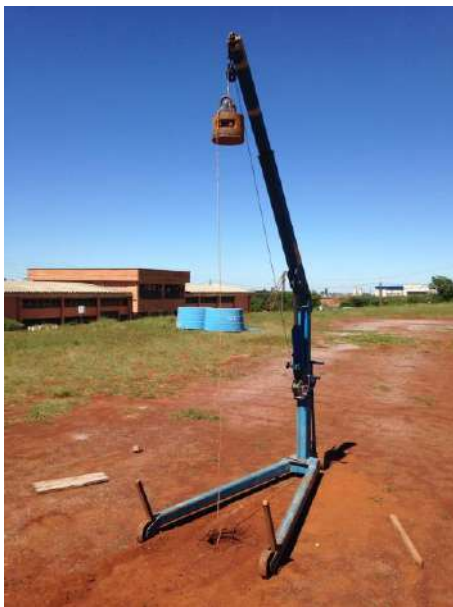
Figura 3 - Bloco içado pronto para queda livre.
