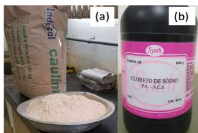
Figura 1. Materiais utilizados nos solos artificiais (a) caulim e (b) cloreto de sódio.
