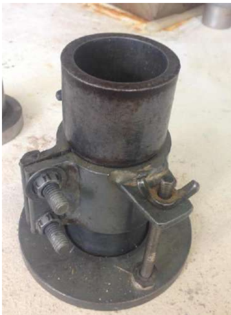
Figura 2. Molde metálico tripartido montado
