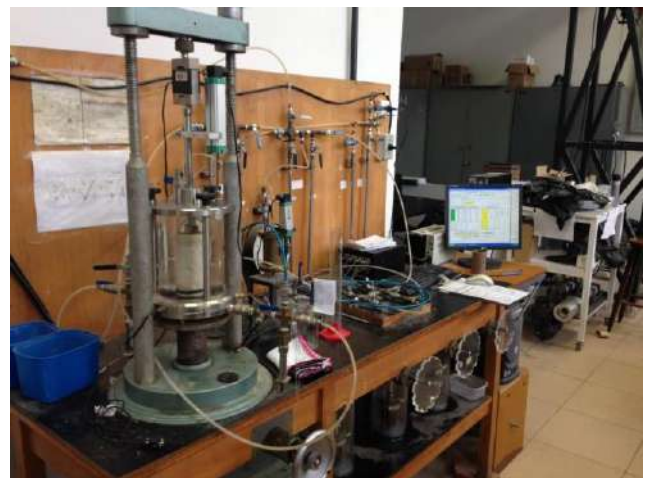
Figura 5. Equipamento do ensaio de resistência à compressão triaxial
