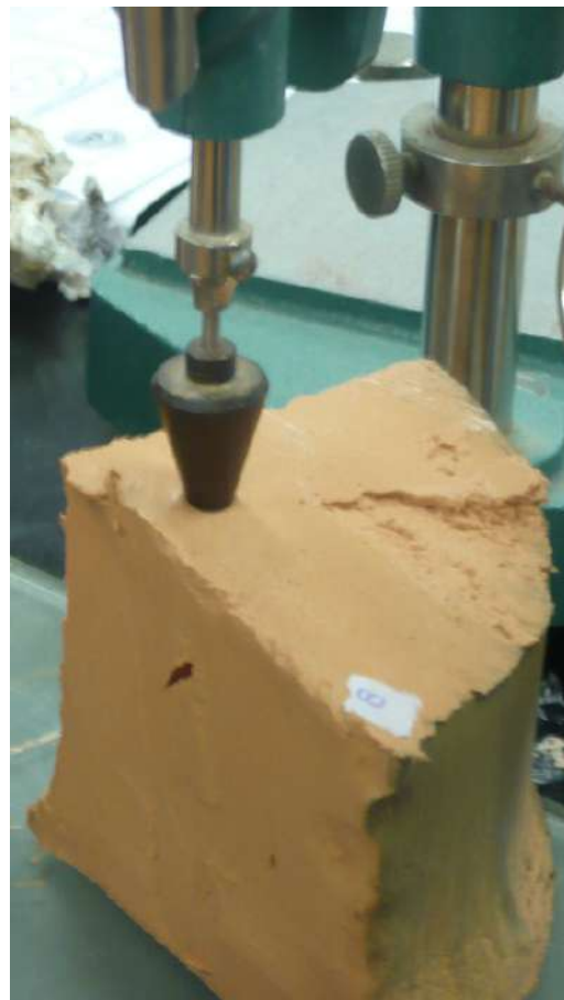
Figura 12. Detalhe do ensaio de cone de queda livre em execução
