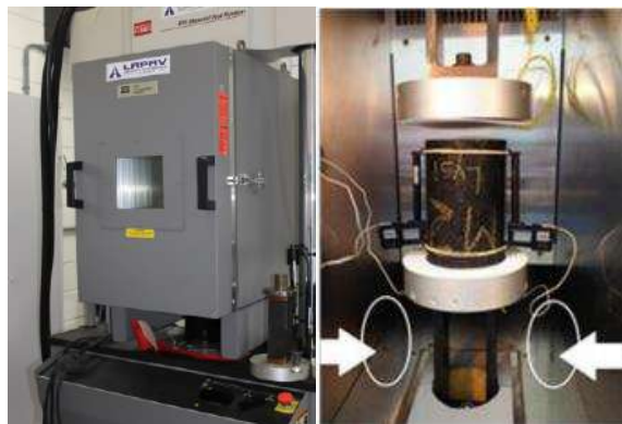
Figura 2: Imagens externas e internas da prensa MTS 810 UTM Test System .
