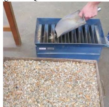
Figura 6 - Quarteamento do material
