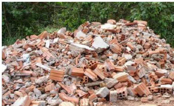
Figura 2. Resíduos de construção civil
