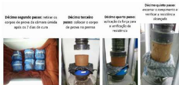
Figura 5. Rompimento corpos de prova ensaio de RCS
