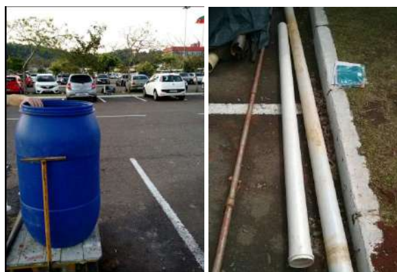
Figura 6. Equipamentos e acessórios utilizados (tambor 200 litros, tubos PVC, hastes, etc)
