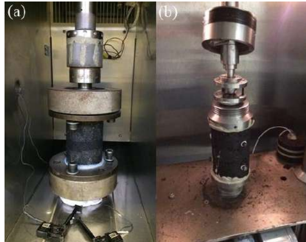
Figura 1. Sistema de ensaio de Fadiga Tração Direta Uniaxial Cíclico: (a) Cenpes e (b) UFC
