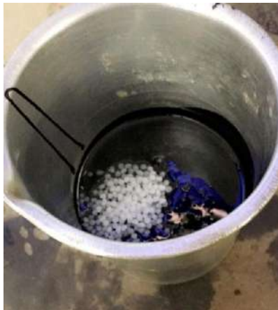
Imagem 01: Aditivo orgânico e ligante asfáltico
