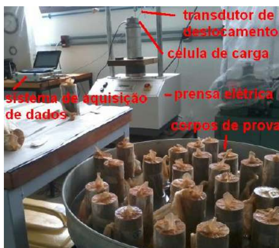
Figura 7. Arranjo experimental para os ensaios de determinação da resistência a compressão simples
