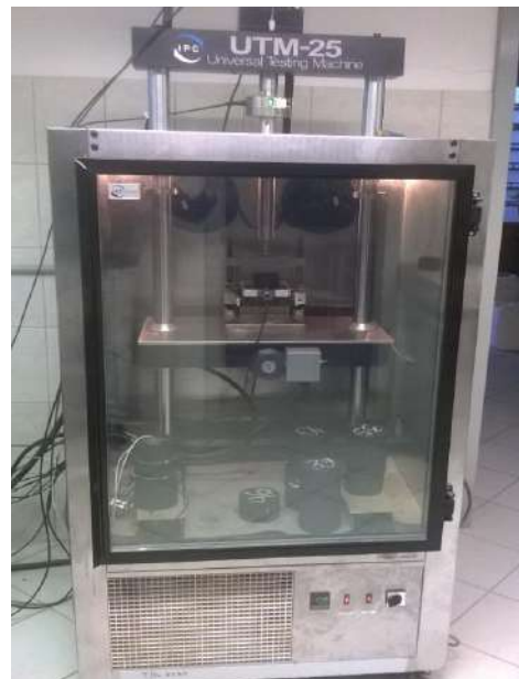
Figura 6 - Prensa UTM-25 utilizada para o ensaio de MR e E*
