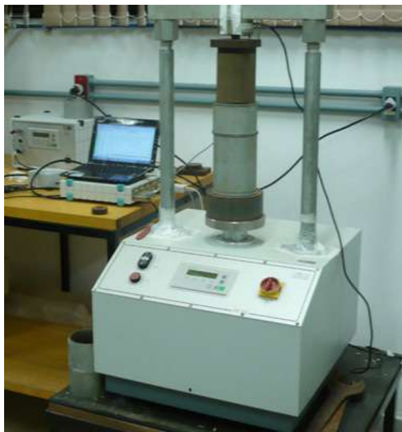
Figura 7. Prensa elétrica utilizada para ruptura dos corpos de prova
